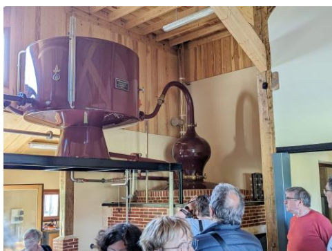
40. La guide nous montre l'alambic dit « à repasse », permettant la double distillation requise pour le Calvados AOC Pays d'Auge
